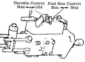
Fig. 2 FUEL INJECTION PUMP
