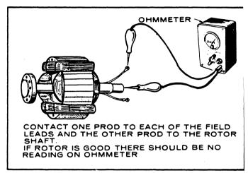
FIGURE 18. TESTING ROTOR FOR GROUNDS
