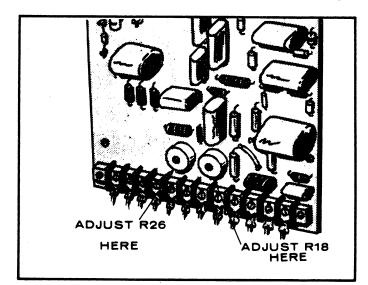
FIGURE 27. ADJUSTING VOLTAGE ON VR21
