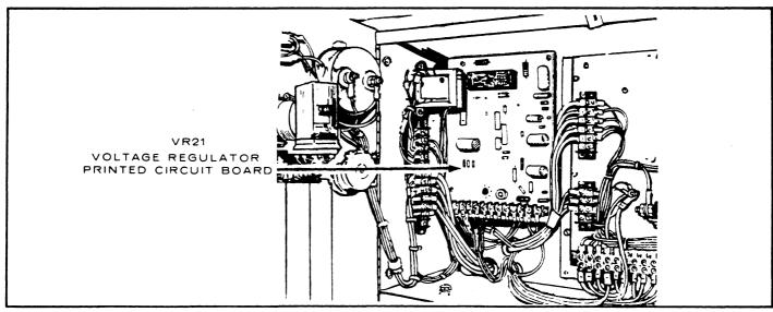
FIGURE 4. VOLTAGE REGULATOR PRINTED CIRCUIT BOARD LOCATION
